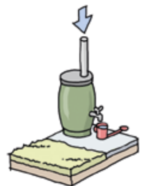
Abb. 8.4 Auffangen des Regenwassers in einer Regentonne zur Gartenbewässerung
