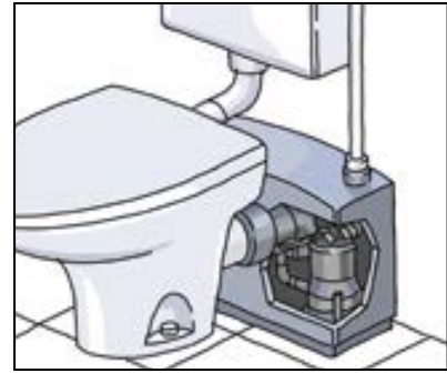
Abb. 16.3 Hebeanlage nach DIN EN 12050 Teil 3 zur begrenzten Verwendung für fäkalienhaltiges Abwasser.
