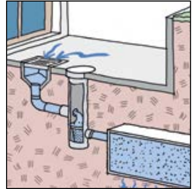
Abb. 29.3 Unterirdische Versickerung durch Rigole
