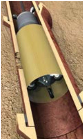
Kurzliner in geschlossener Bauweise
